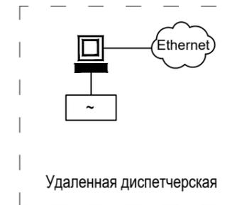
В качестве сети передачи данных между лифтовым блоком версии 7.2 (далее ЛБ v7.2) и диспетчерским пунктом, предусматривается установка 4G модема и 4G роутера, к которым подключается блок ЛБ7.2 (временно). После проведения провайдером сети интернет, блок переподключить к Ethernet со статическим IP адресом.
